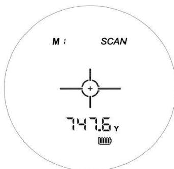
**M2 – Mode scan** : appuyez sur le bouton d'alimentation **rouge** et maintenez-le enfoncé et déplacez-vous à gauche et à droite de la cible pour avoir la distance de la cible au lieu de l'arrière-plan (cette fonction est utilisée dans des conditions où il y a des arbres ou d'autres objets derrière).
